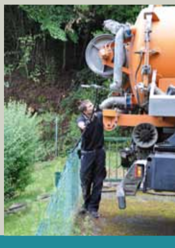
Nettoyage haute pression de canalisations Arbeiten mit dem Saug-Druck-Fahreug
